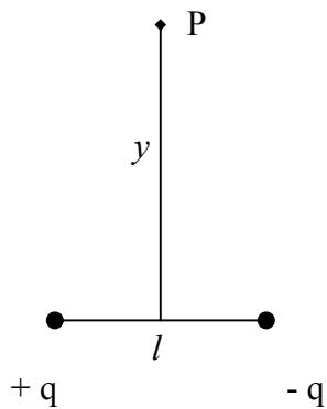
Figuren viser en elektrisk dipol. Det er to ladninger med henholdsvis  $+q$  og  $-q$ . Avstanden mellom ladningene er  $l$ .
