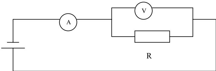
Figuren viser en krets der resistansen i amperemeteret er  $0,500\ \Omega$ , i voltmeteret er  $1200\ \Omega$  og i batteriet er  $0,200\ \Omega$ . Batteriets ems er  $12,00\text{ V}$ . Motstanden  $R$  i kretsen har resistansen  $23,50\ \Omega$ .
