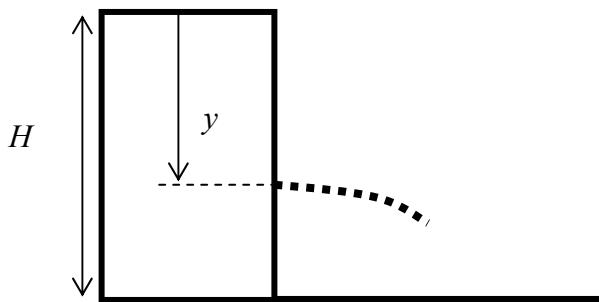
Figuren viser en beholder full med vann. Det strømmer vann horisontalt ut fra et hull i avstanden  $y$  fra toppen. Beholderen har høyden  $H$ . Det kan vises at den farten vannet har i åpningen er  $v_x = \sqrt{2gy}$  når beholderen hele tiden er full.
