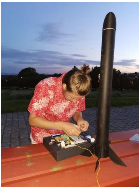
Figur 2. Venstre: Siste innstilling av kontrollenheten (launch pad) før oppskyting i Fysikkbakken. Høyre: prototype av en løsning for å kunne styre raketten ved bruk av thrust vector control (TVC). Kortet til høyre viser kontrollenheten basert på en Arduino-løsning som styrer holderen til rakettmotoren ved hjelp av to trinnmotorer (til venstre i bilde). Bilder: www.portalspace.no .
