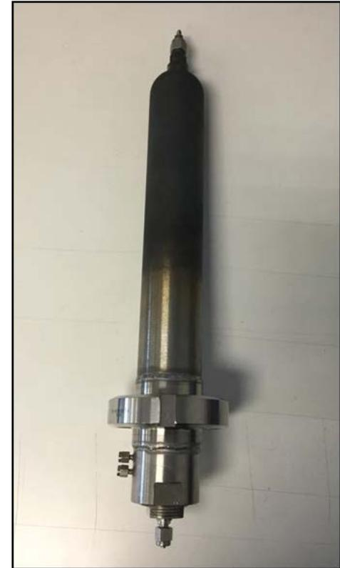
Prototipo de un tubo del electrolizador
