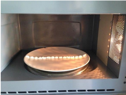
Figur 2: Bilde av oppsett. Mikrobølgene kommer fra høyre i bildet.
